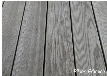
Abb. 29 Vorher / Nachher: Thermoholz nach ca. 6 Monaten in direkter Sonneneinstrahlung.
